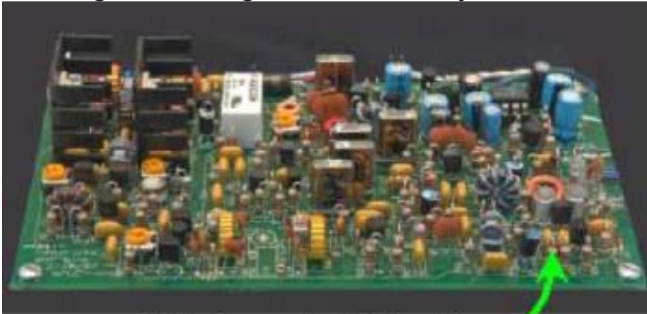
Mida la frecuencia del OFV aquí (rabillo superior de R-27)
