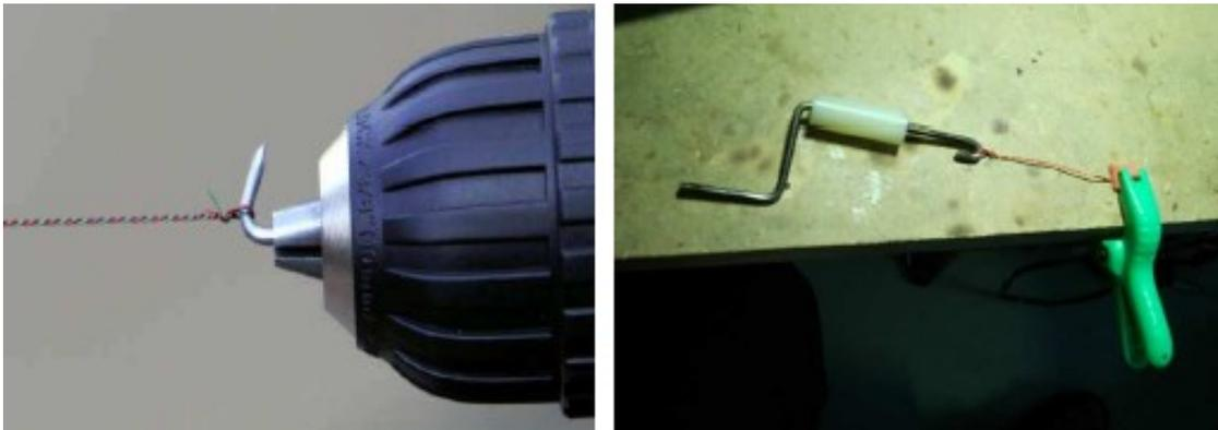
2. También tendrá que retorcer alambres esmaltados de cobre para bobinar posteriormente los transformadores toroidales. Vd. puede conseguirlo con el método del taladro y el clavo torcido o fabricarse Vd. mismo un retorcedor manual utilizando alambre rígido y un trocito de tubo de plástico.
