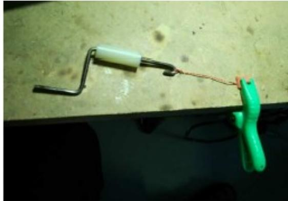
Vd. tendrá que retorcer alambres de cobre esmaltados para bobinar posteriormente los transformadores toroidales. Esto se puede hacer con el método del taladro y el clavo torcido o fabricarse Vd. mismo un retorcedor manual utilizando alambre rígido y un trocito de tubo de plástico.
